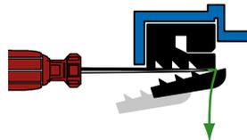
Se necessario (area di densità 2), Rimuovere l'anello di guarnizione e tirare fuori tutto l'intorno. **Non può essere rimontata!**
