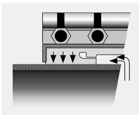
Il giunto di riparazione con tenuta idraulica.
