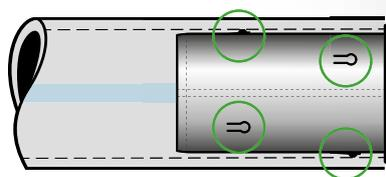
Le borchie/molle di tensione tengono la bussola d'appoggio saldamente posizionata nel tubo PE.
