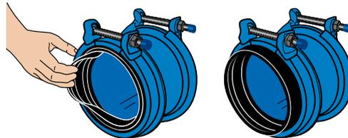
Se necessario (area di densità 2), tirare la parte interna della guarnizione verso l'esterno. **Se guarnizione pulita, può essere invertita di nuovo!**
