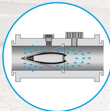
Il sistema di tenuta membrana evita il riflusso.
