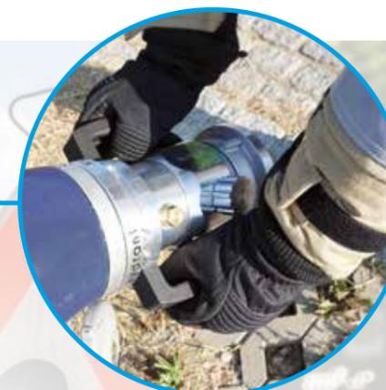
Scarico della pressione con arresto di sicurezza.
