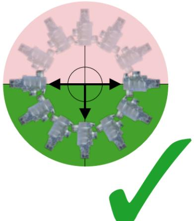
**7** Der Systemtrenner BA-IMT reagiert auf kleinste Druckschwankungen. Ein leichtes Tropfen im Ruhe- und Fließzustand ist bei Druckschwankungen möglich.
