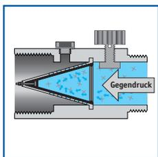
Il sistema di tenuta membrana conica evita il riflusso.
