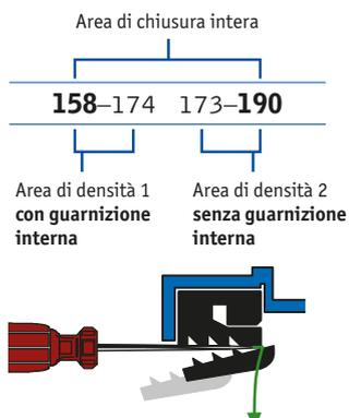
Se necessario (area di densità 2) svitare la guarnizione di isolamento interna e rimuoverla.
